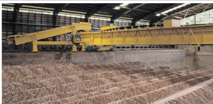
Figure 3.2.16. Méthode Chevcon avec système de préhomogénéisation pour stockages continus.
