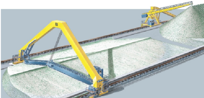
Figure 3.2.10. Méthode de stockage en strates. Collecteur à portique.
